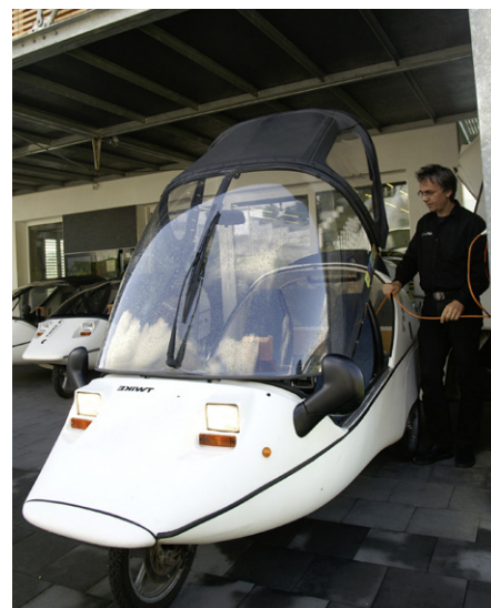
Das Twike nutzt Batterien aus Lithium-Eisenphosphat (LiFePO 4 ). Die Speicherelemente können rund sieben Jahre im Twike genutzt werden.
