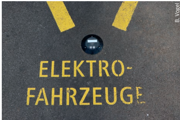
Jeder Parkplatz zum Laden von Elektromobilen ist mit einem Sensor ausgerüstet. Über eine App lässt sich in Erfahrung bringen, welcher Ladeplatz zurzeit frei ist.
